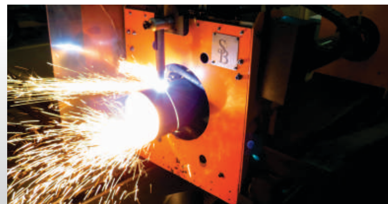
Máquina CNC para corte de tubos
